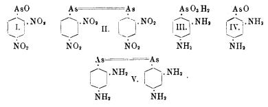
Von diesen Verbindungen sollen heute das Dinitrophenyl-arsenoxyd (Formel I), das Tetranitro-arsenobenzol (Formel II) und das Tetramino-arsenobenzol (Formel V) eingehender behandelt werden, da sie chemisch die bemerkenswertesten Resultate ergeben haben.
